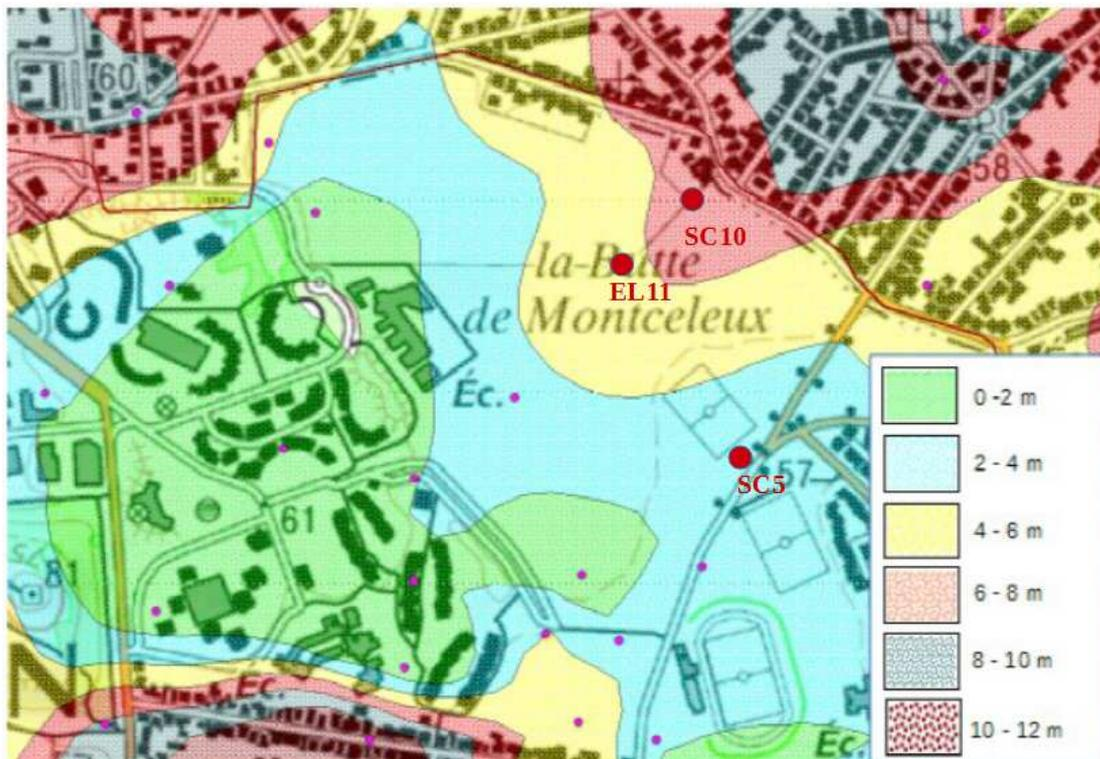
Figure n°7 : Carte interpolée de l'épaisseur des Marnes infragypseuses et localisation des nouveaux sondages (point de plus gros diamètre)
